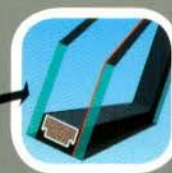
Edzett külső üveg, belső üveg alacsony emissziós bevonattal. Az üvegek közötti rés nemesgázzal töltött.
