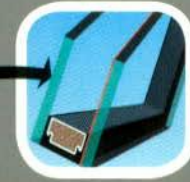
Edzett külső üveg, belső üveg alacsony emissziós bevonattal. Az üvegek közötti rés nemes- gázzal töltött.
