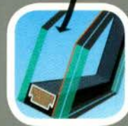
Üvegezés külső edzett üveggel és belső ragasztott (biztonsági) üveggel. Az üvegek közötti rés nemesgázzal töltött.
